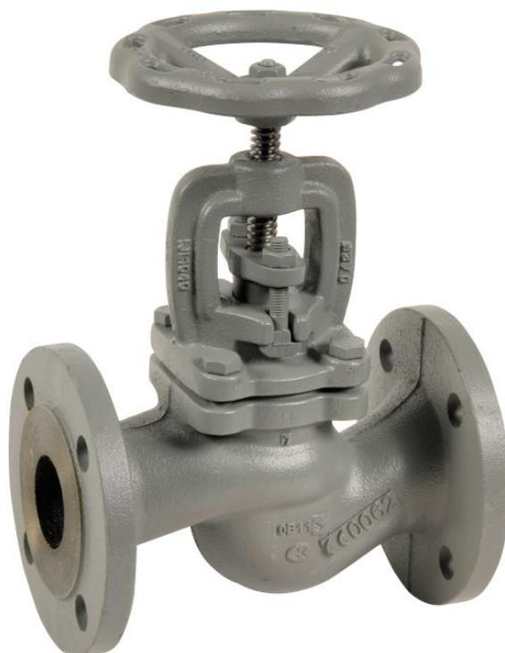
**Dimensions :** DN15 au DN200**Raccordement :** A brides R.F. PN16**Température Mini :** -10°C**Température Maxi :** +300°C**Pression Maxi :** 16 Bars**Caractéristiques :** Tige et volant montants tournants
