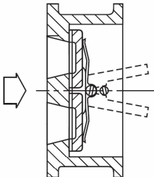
**Positionner l'axe du clapet de manière verticale pour que le fluide exerce la même pression sur les 2 battants**
